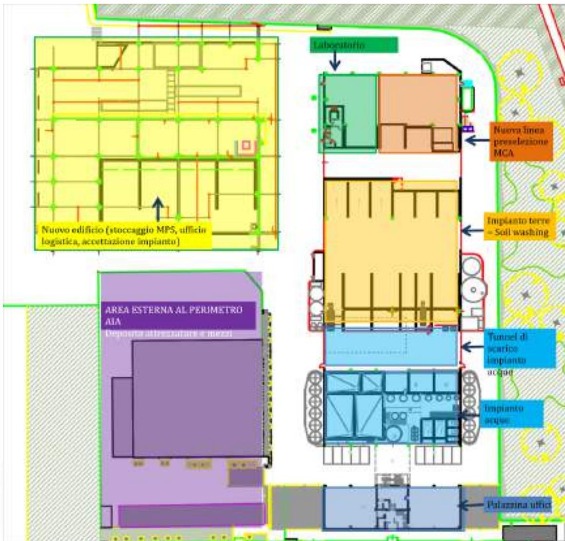
Figura 9: Planimetria Sito SEMP (in giallo nuovo capannone)
